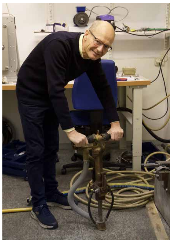
Hans Lindell visar en mejselmaskin som används i stenbrott för att spräcka stenblocken.
